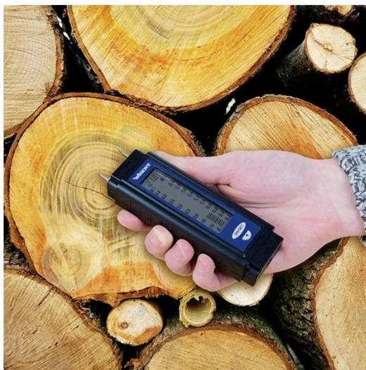
Slika 1.2. Prikaz mjerenja vlažnosti drva
