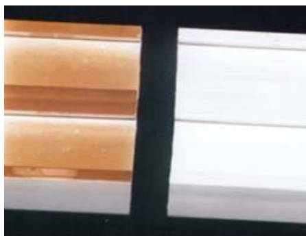
Slika 3.3. PVC uzorak prije (desno) i nakon (lijevo) UV ispitivanja
