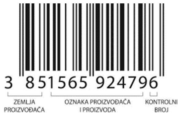
Slika 6. Struktura bar koda
