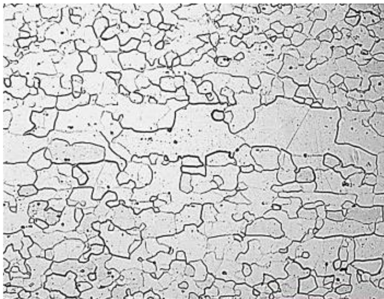
Slika 2.2 Mikrostruktura feritnih korozijski postojanih čelika [19]
