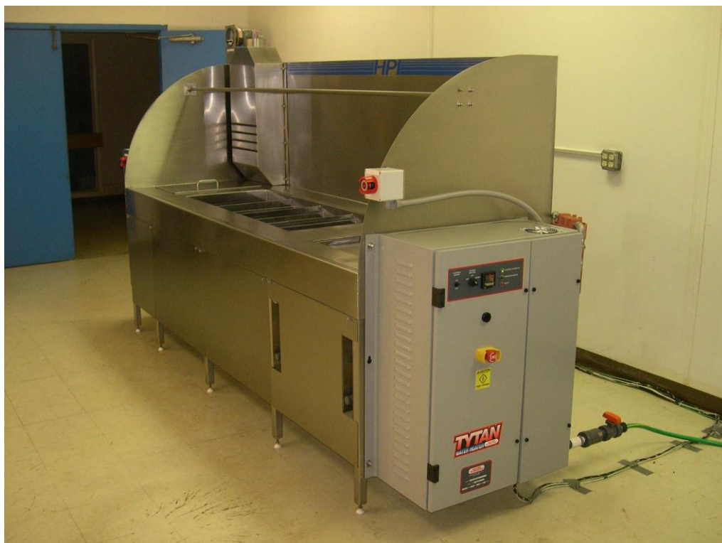
Slika 3.6 Oprema za izvođenje tretmana u otopini dušične kiseline [41]
