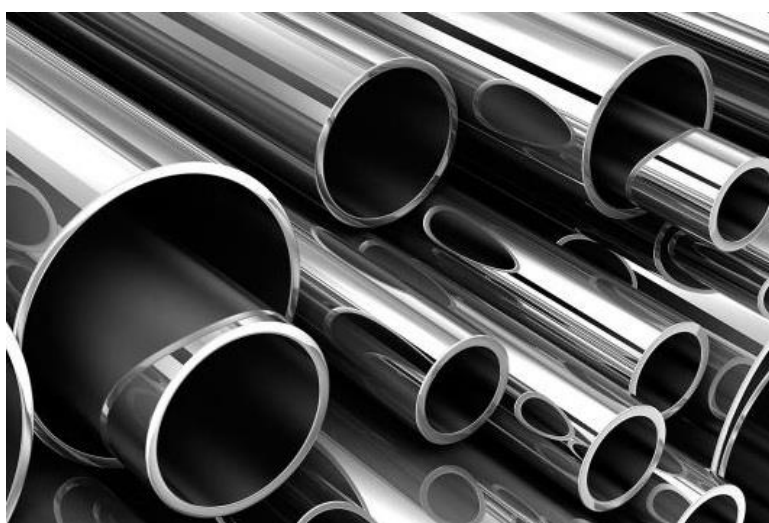
Slika 2.5 Cijevi izrađene od austenitnog korozijski postojanog čelika [22]
