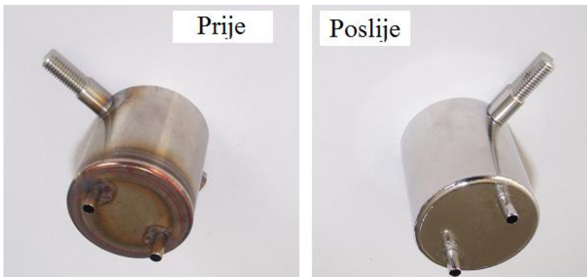
Slika 3.7 Proizvod prije i poslije procesa pasivacije [42]
