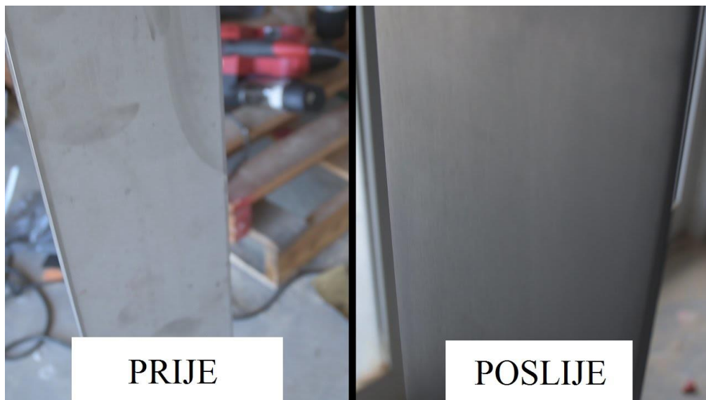
Slika 3.2 Korozijski postojani čelik prije i poslije brušenja [36]
