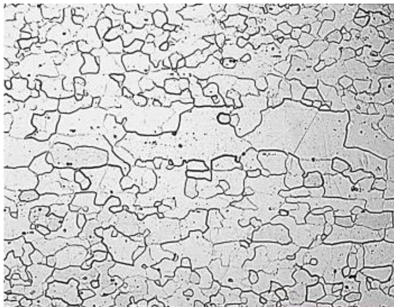
Slika 2.2 Mikrostruktura feritnih korozijski postojanih čelika [19]
