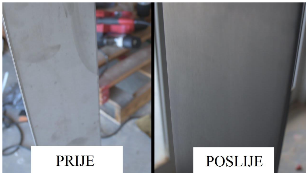
Slika 3.2 Korozijski postojani čelik prije i poslije brušenja [36]
