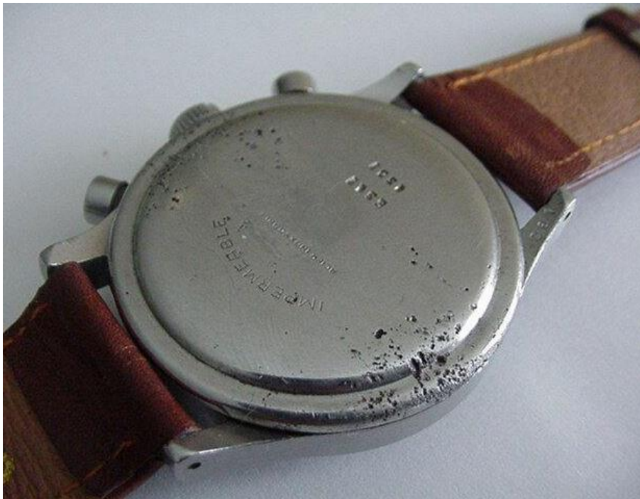
Slika 2.10 Točkasta korozija ručnog sata [28]
