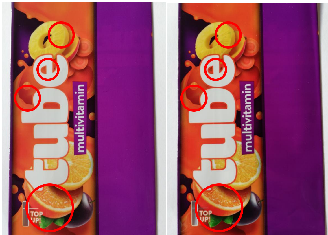
Slika 7.8 Usporedba prve otisnute etikete s novim tiskovnim formama (lijevo) i zadnje etikete nakon tiska cijele naklade od 500.000 etiketa (desno)
