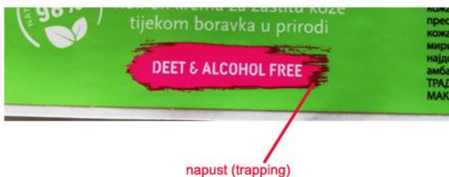
Slika 6.8 Utjecaj nepravilno definiranog i otisnutog napusta
