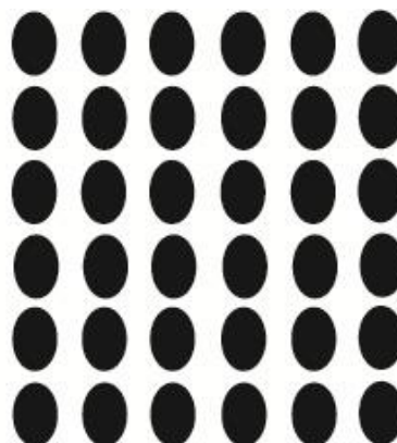
deformacija rasterskog elementa u tisku "efekt smicanja"
