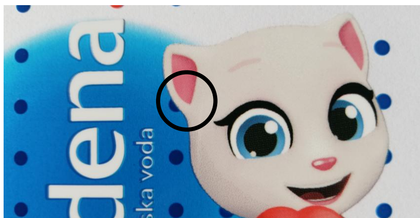
Slika 7.12 Smanjeni pritisak između temeljnog i tiskovnog cilindra
