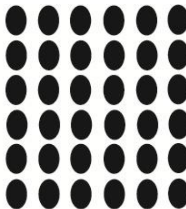
deformacija rasterskog elementa u tisku "efekt smicanja"
