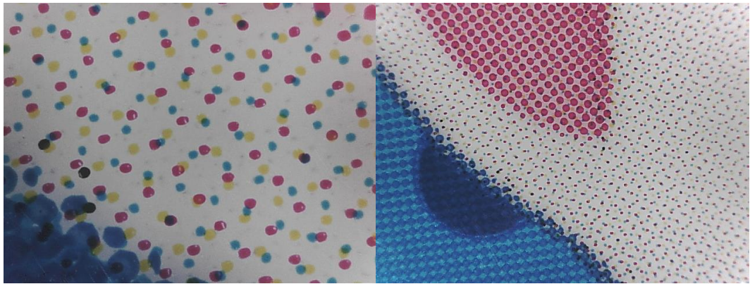
Slika 7.11 Deformacija rastera crne boje zbog prevelikog pritiska na tiskovnu površinu
