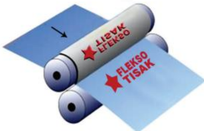
Slika 2.11 Distorzija tiskovne forme u fleksotisku
