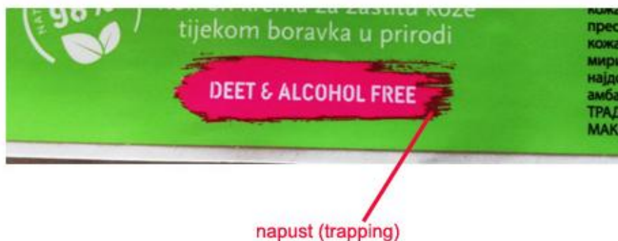
Slika 6.8 Utjecaj nepravilno definiranog i otisnutog napusta
