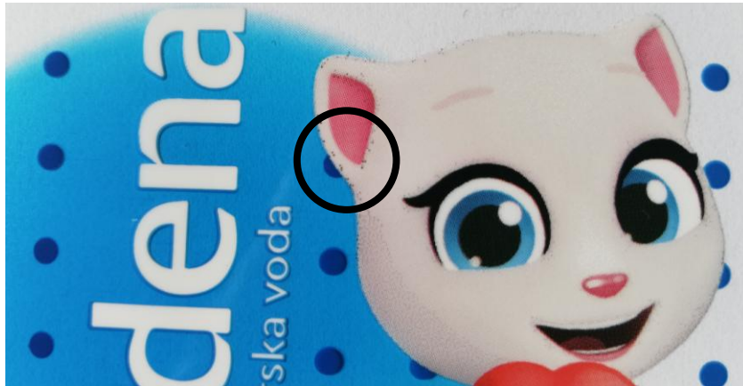
Slika 7.11 Deformacija rastera crne boje zbog prevelikog pritiska na tiskovnu površinu
