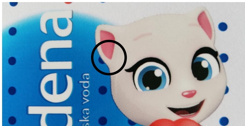
Slika 7.12 Smanjeni pritisak između temeljnog i tiskovnog cilindra
