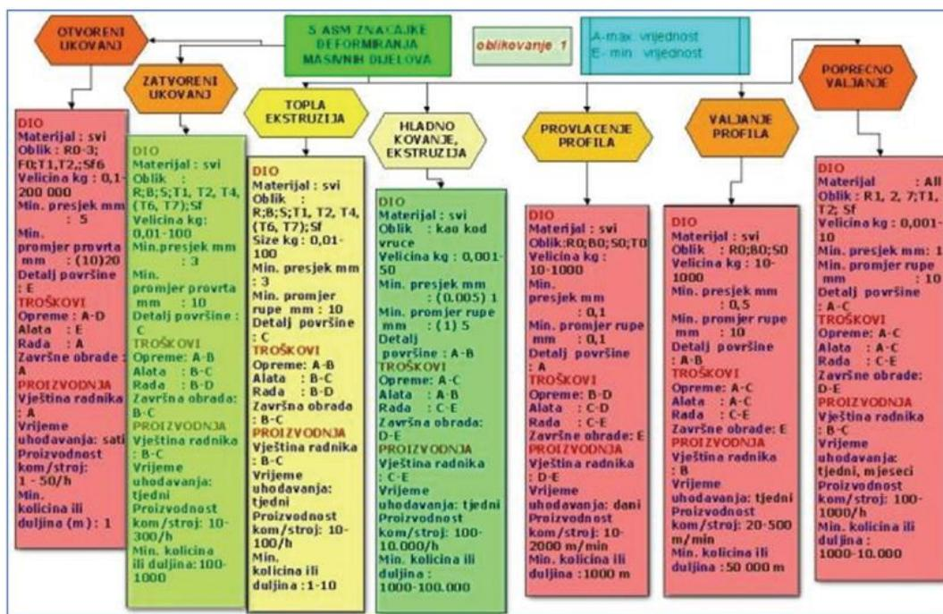
Tablica 4.4 ASM značajke obrade metala deformiranjem, [1]
