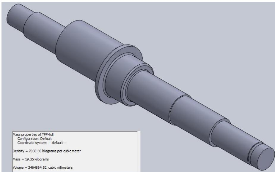
Slika 5.1 Podaci o masi i volumenu iz SolidWorks-a
