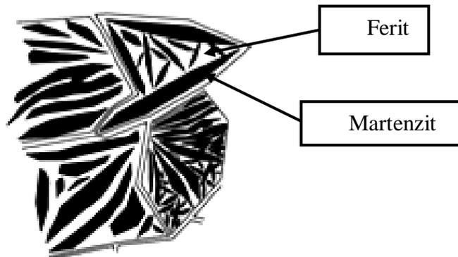
*Slika 3.15 Shematski prikaz mikrostrukture martenzitnog visokočvrstog čelika [33]*
