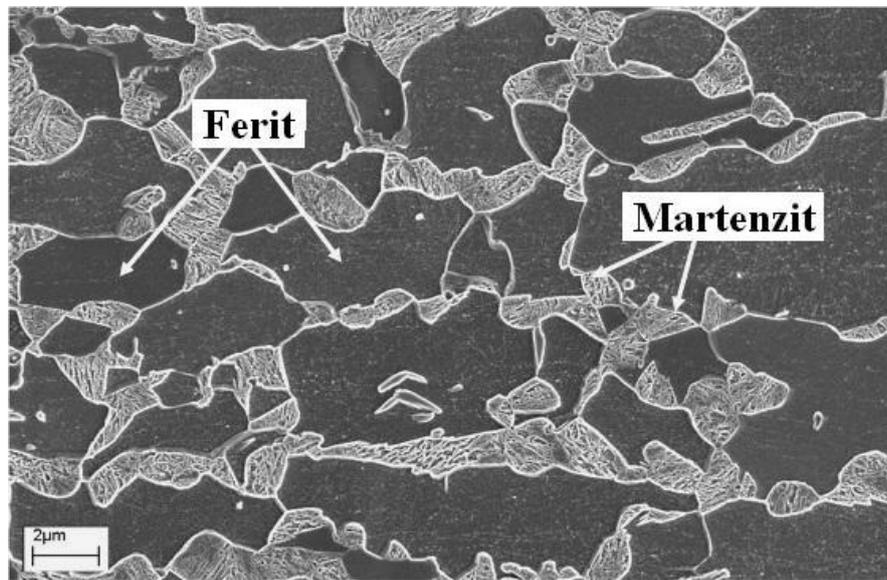
*Slika 3.8 Mikrostruktura čelika sa duplom fazom na mikroskopu [30]*
