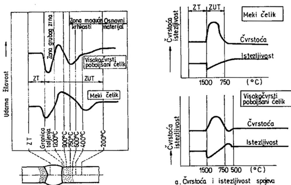
*Slika 3.4 Promjena mehaničkih svojstava u zavarenom spoju [22]*
