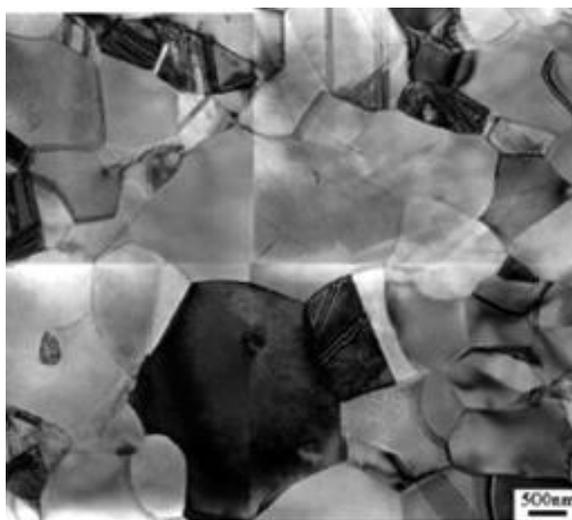
*Slika 3.18 Mikrostruktura visokočvrstih čelika sa srednjim sadržajem mangana [46]*
