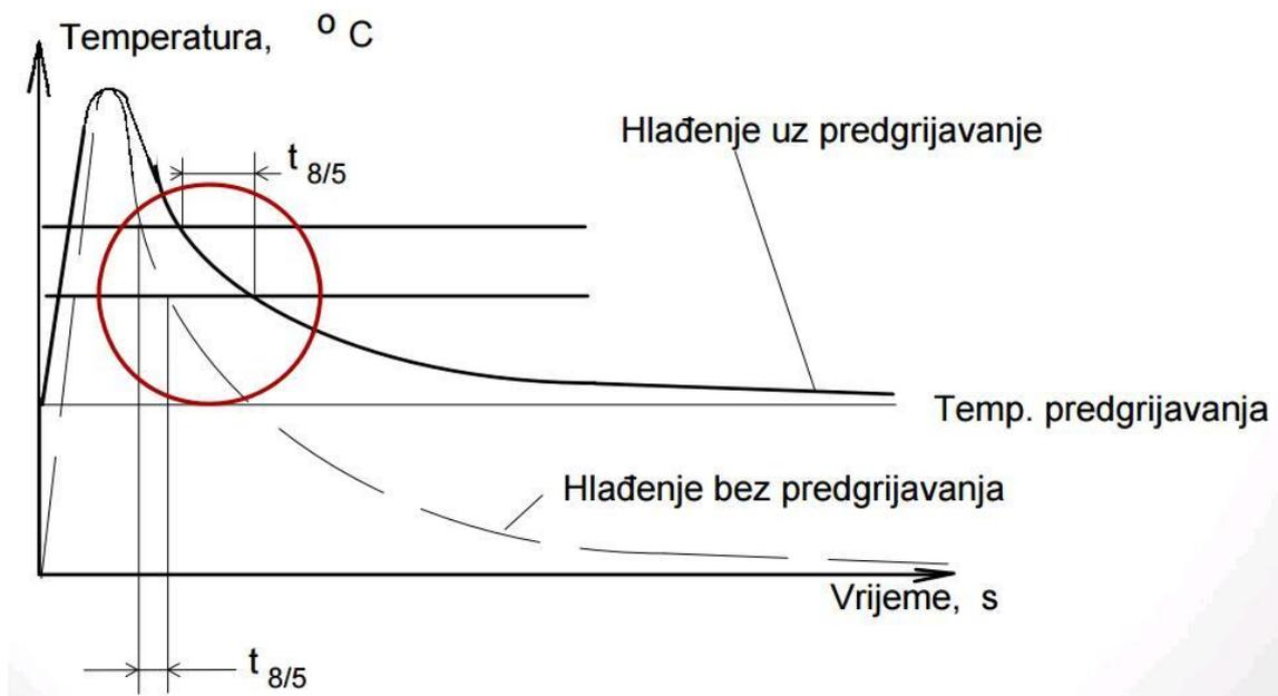
**Dijagram 3.11** Temperatura predgrijavanja prije postupka zavarivanja [24]
