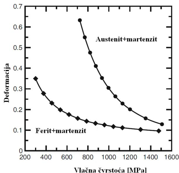
*Dijagram 3.20 Odnos vlačne čvrstoće i deformacije za različite mikrostrukture [25]*
