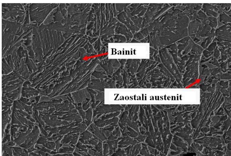
*Slika 3.19 Mikrostruktura TRIP potpomognutog bainitno feritnog čelika (TBF) [19]*
