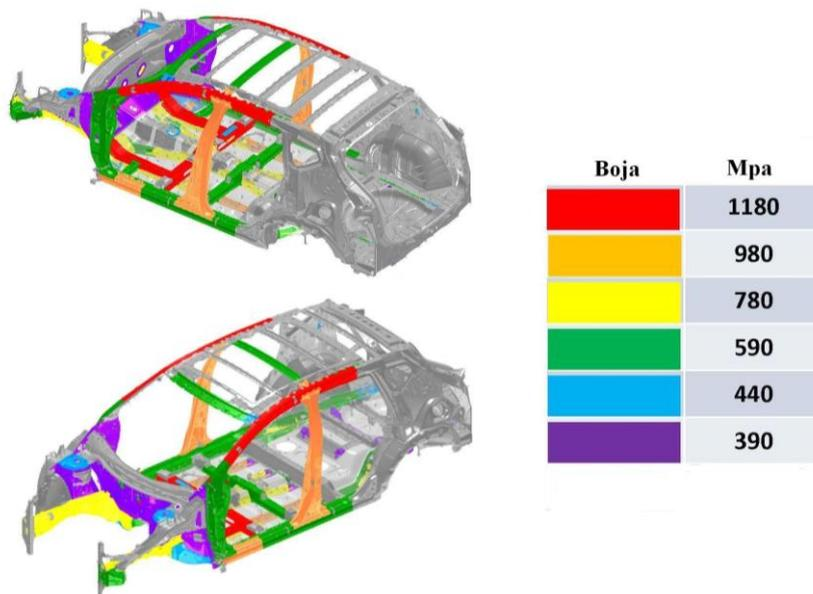
*Slika 3.1 Primjer vlačnih čvrstoća materijala različitih dijelova šasije [16]*
