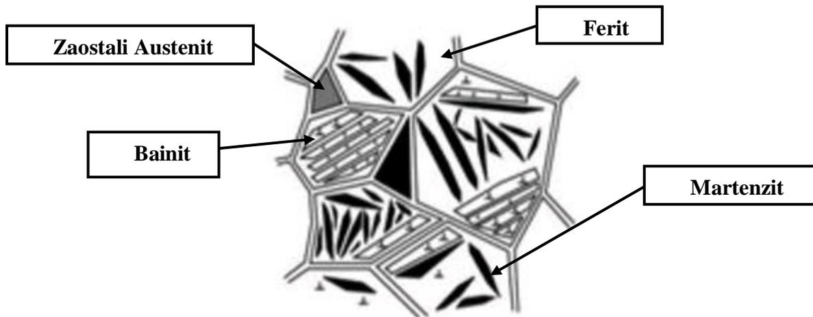
*Slika 3.10 Shematski prikaz mikrostrukture čelika složene faze [33]*
