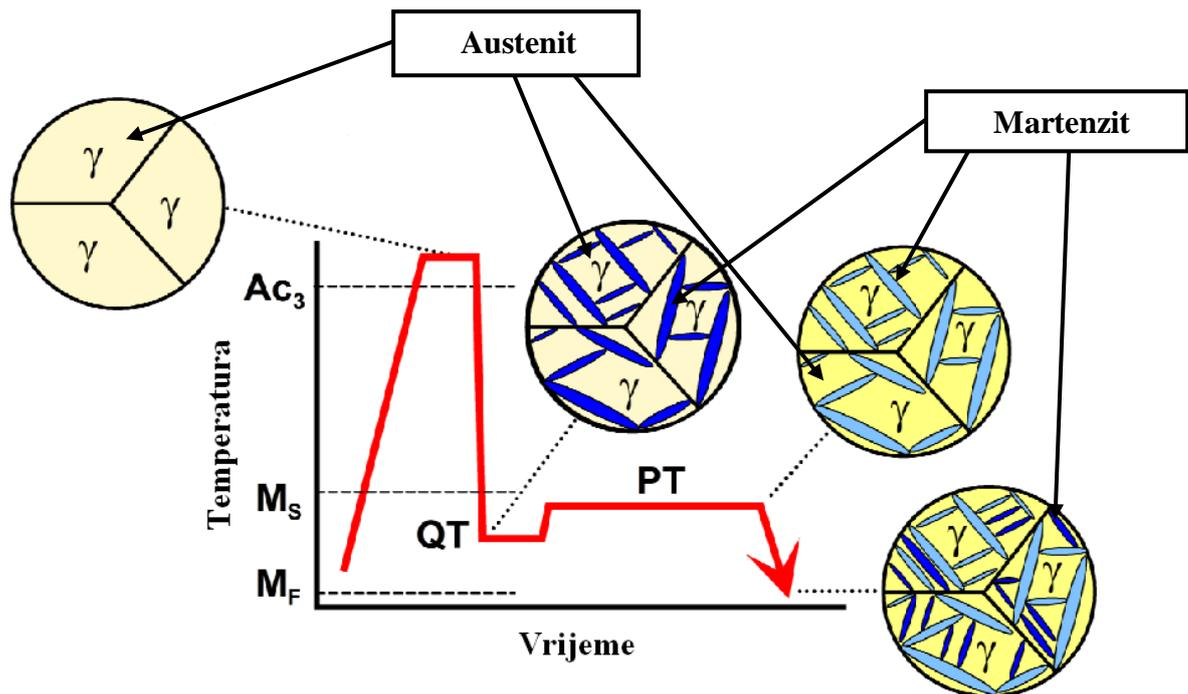
*Dijagram 3.23 Postupak dobivanja Q&P čelika [47]*
