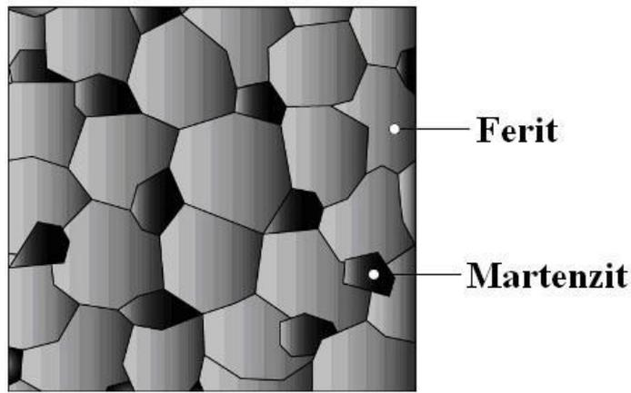
*Slika 3.7 Shematski prikaz mikrostrukture čelika sa duplom fazom [27]*
