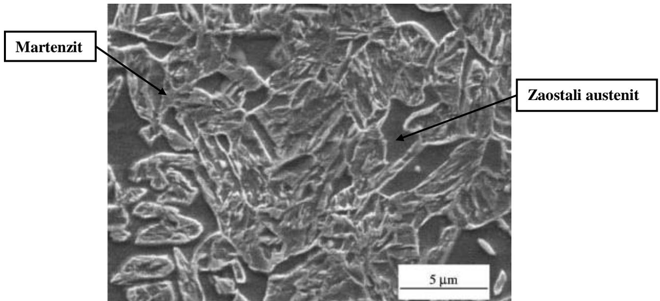
*Slika 3.20 Mikrostruktura Q&P čelika [48]*
