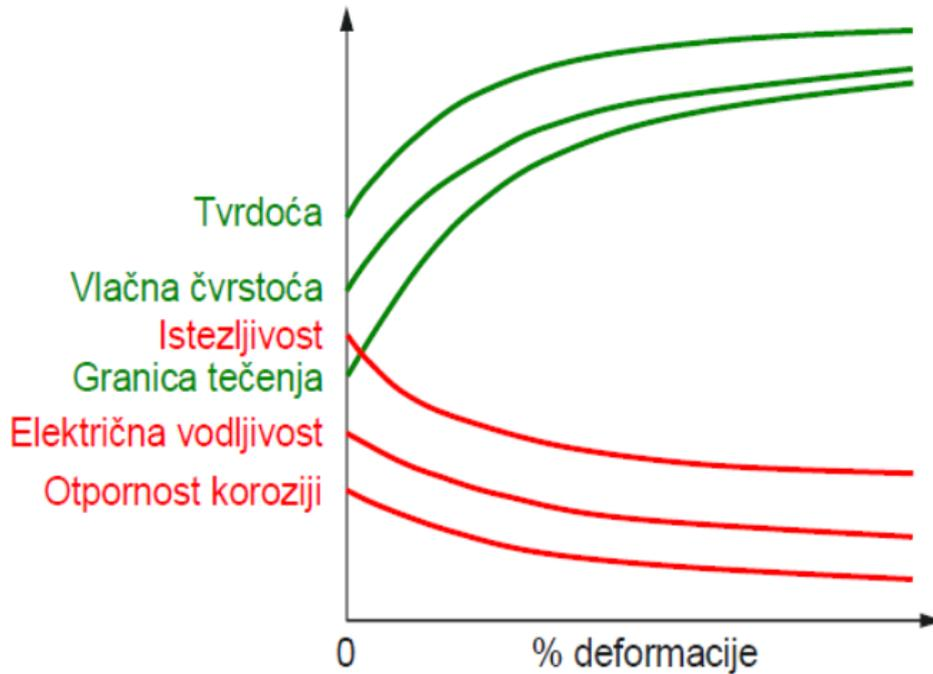
**Dijagram 3.5** Promjene mehaničkih svojstava uslijed hladne deformacije [22]
