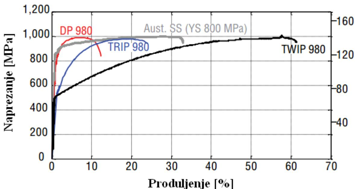
*Dijagram 3.19* Dijagram produljenja i naprezanja za austenitni nehrđajući čelik i druge čelike (DP, TWIP, TRIP) [44]
