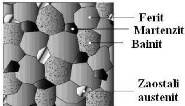
*Slika 3.12 Shematski prikaz mikrostrukture TRIP čelika [34]*
