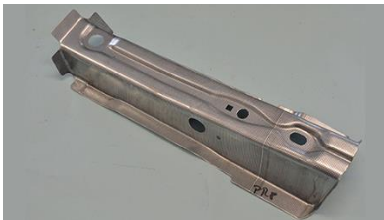
Slika 3.11 Komponenta šasije automobila izrađena od čelika složene faze [34]
