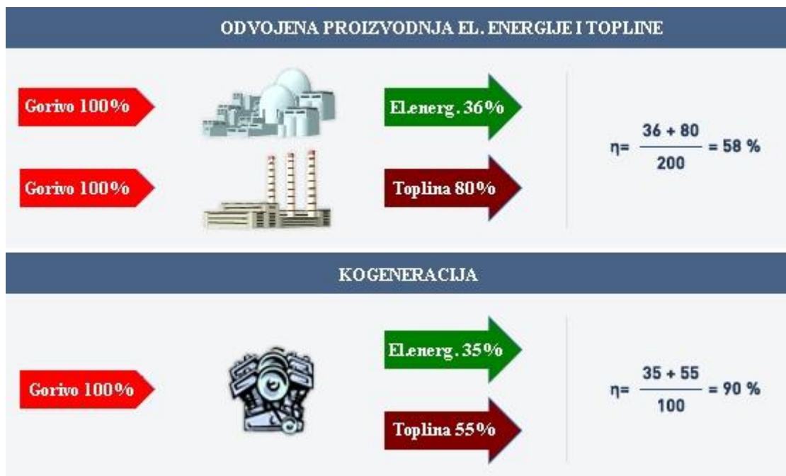
Slika 1.1: Prednost kogeneracije pred odvojenom proizvodnjom električne energije
