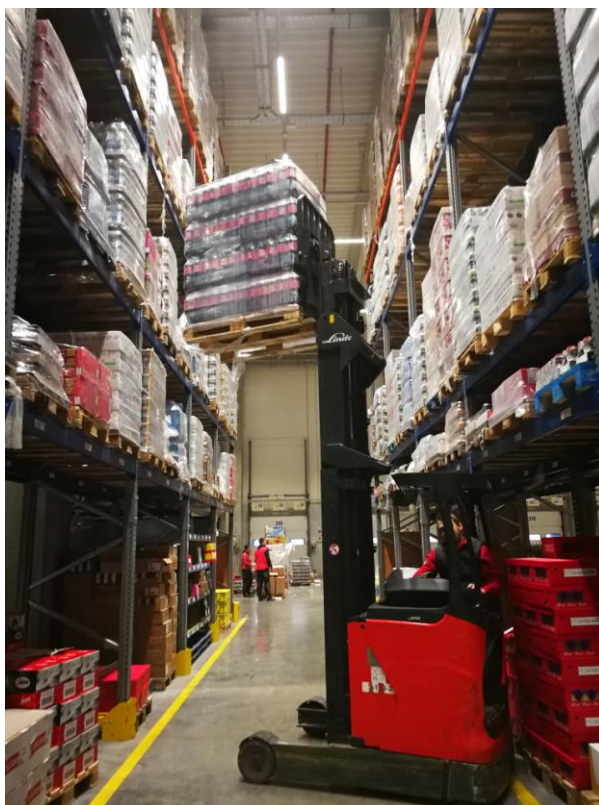
Slika 4.5 Odvoz palete sa prijernih blokova te njihov smještaj na regale
