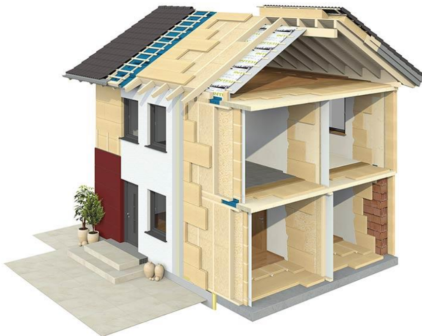
Slika 4.17 Izolacija obiteljske kuće od drvenih vlakana
