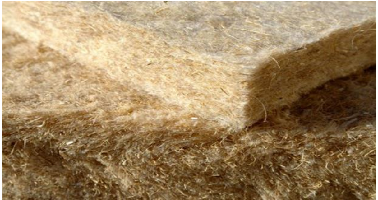
Slika 4.22 Izolacijske ploče od konoplje
