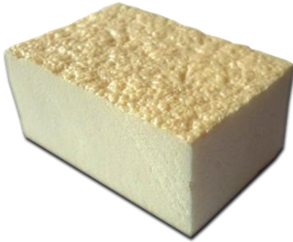
Slika 4.8 Poliuretanska pjena proizvedena u kalupu
