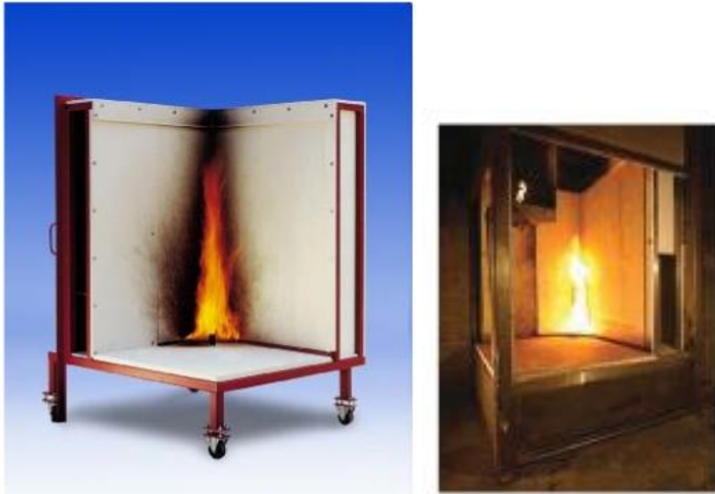
Slika 5.1 Aparatura za provođenje ispitivanja prema SBI metodi
