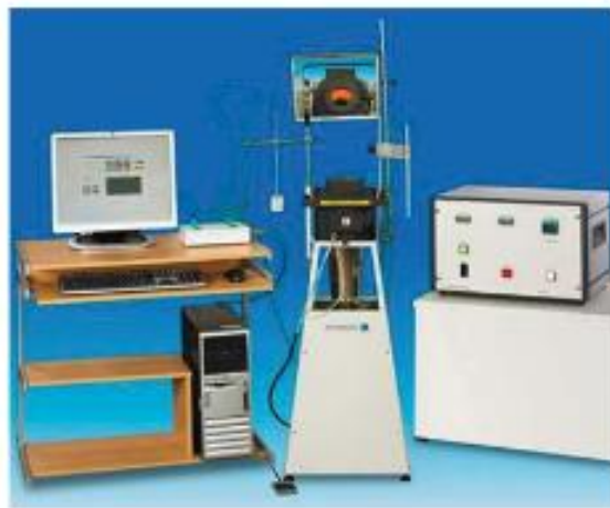
Slika 5.4 Aparatura za provođenje ispitivanja prema EN ISO 1182 metodi
