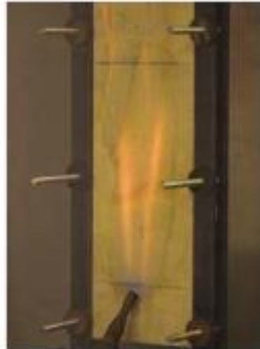
Slika 5.2 Aparatura za provođenje ispitivanja SFI metodom
