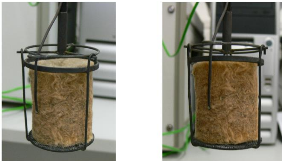
Slika 5.5 Uzorak kamene vune prije i poslije ispitivanja (promjena mase od 3,7%)
