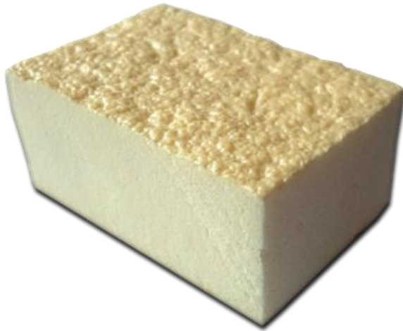
Slika 4.8 Poliuretanska pjena proizvedena u kalupu
