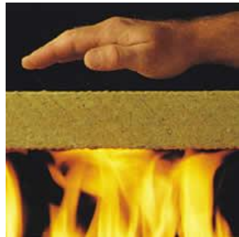
Slika 4.2 Niska toplinska provodljivost mineralne vune
