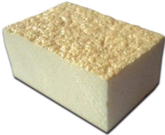
Slika 4.8 Poliuretanska pjena proizvedena u kalupu
