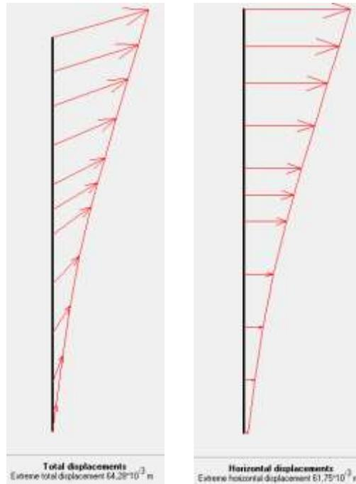
Slika 4.16. Pomaci zaštitne nakon konačnog iskopa (-5,00m)
