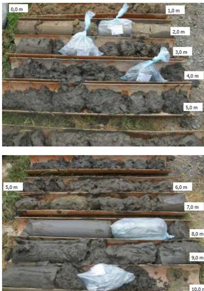
Slika 3.4. Nabušena jezgra bušotine.
