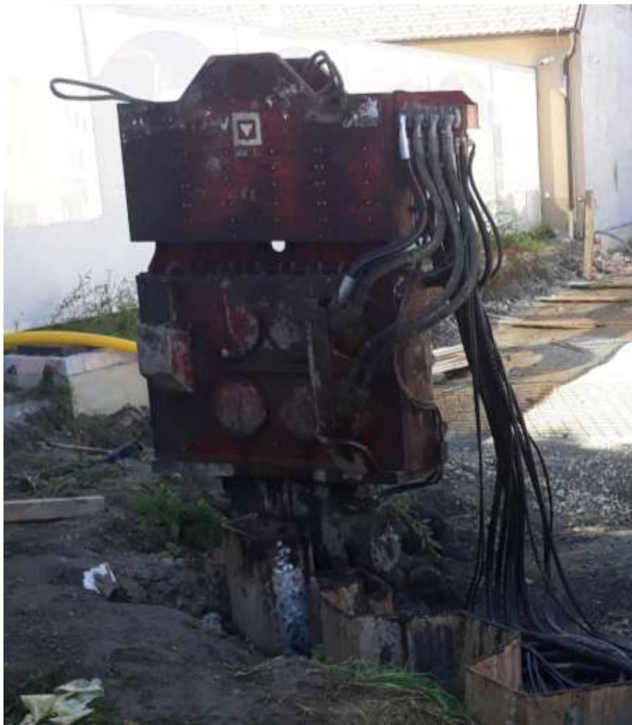
Slika 5.3. Nastavak za zabijanje žmurja.
