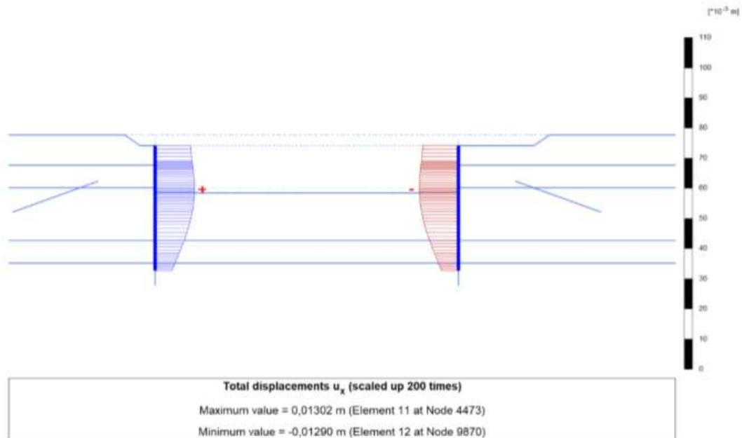
Slika 4.4. Maksimalni horizontalni pomak potporne konstrukcije – konačan iskop tla (ispumpavanje vode)
