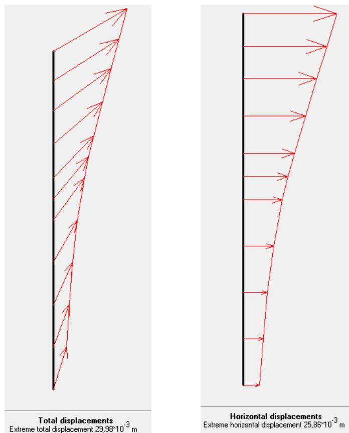
Slika 4.12 . Pomaci zaštite nakon konačnog iskopa(-4,50m)
