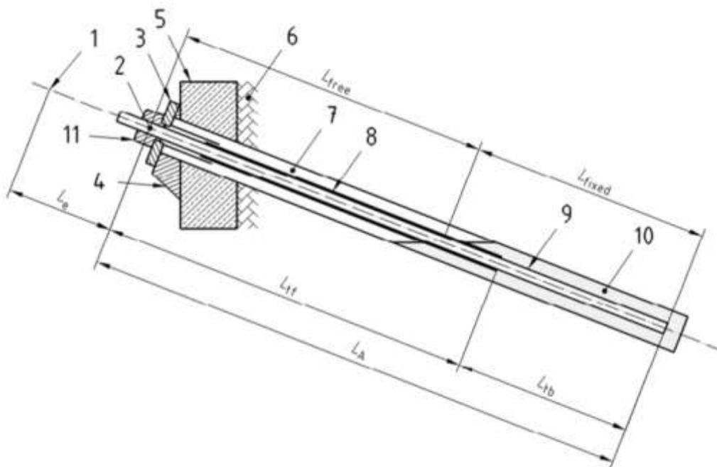
Slika 2.15. Geotehničko sidro.
