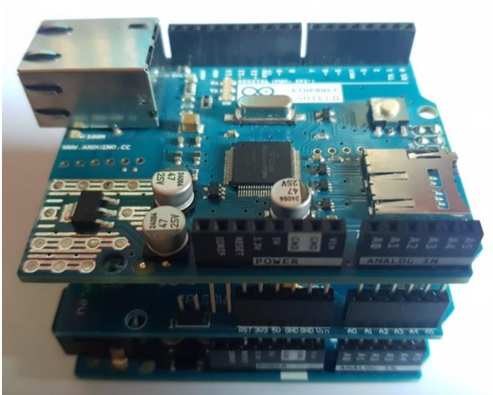
Slika 6.56 Arduino, Ethernet modul i RTC modul
