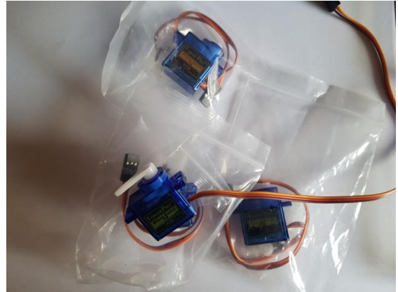
Slika 6.48 Izgled servo motora
