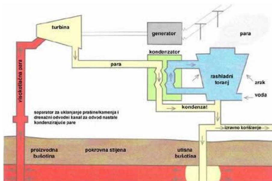
Slika 4.1. – Princip suhe pare [11]
