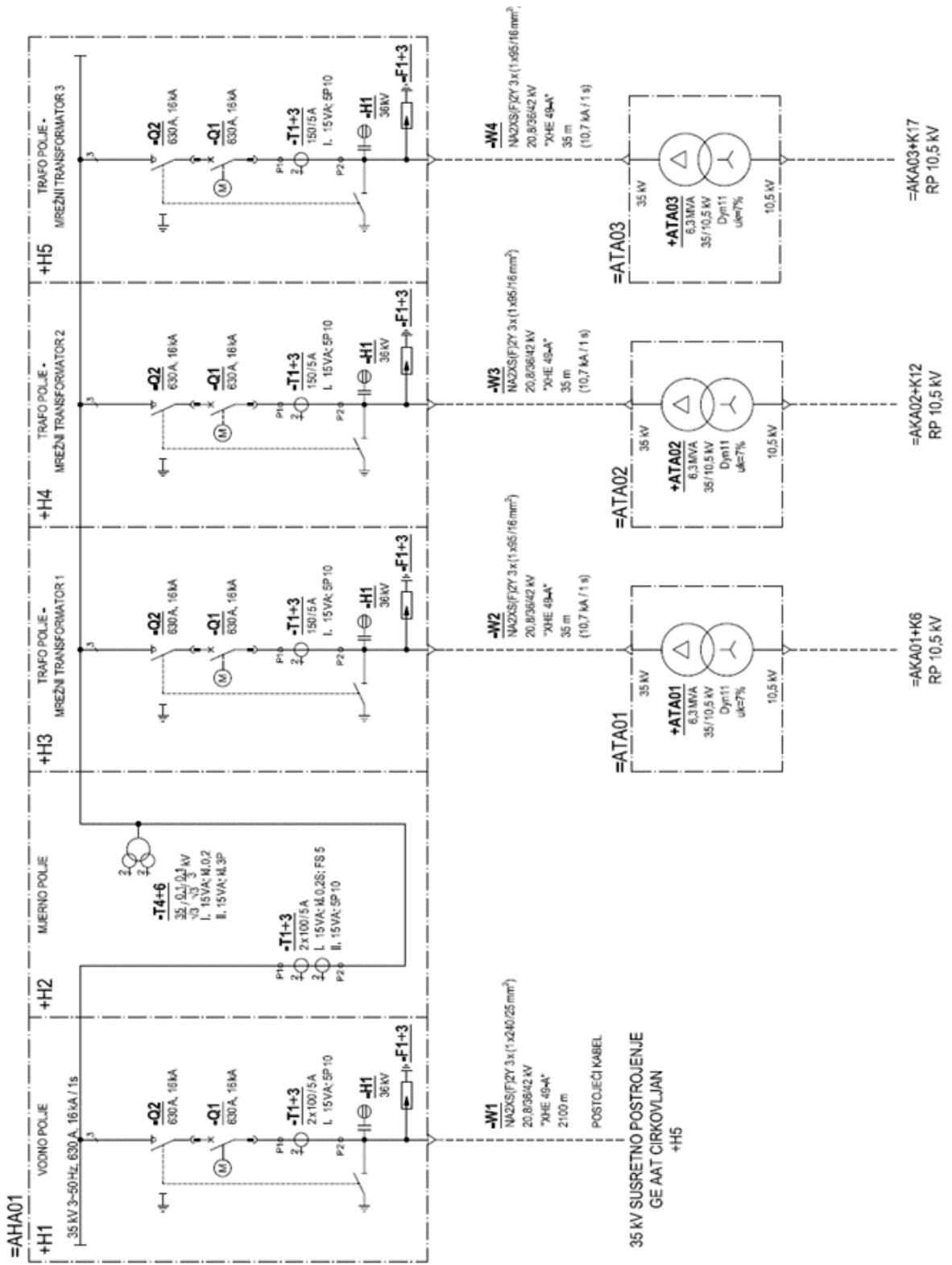
Slika 6.3. – 35kV rasklopljeno postrojenje (Draškovec) [17]
