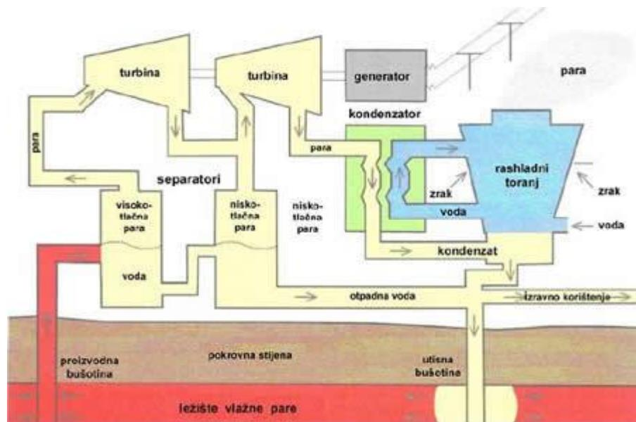
Slika 4.2. – Geotermalna elektrana s dvostrukim isparavanjem [12]
