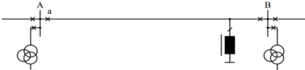
Slika 4.6 Kompensacijska prigušnica direktno priključena na vod[20]
