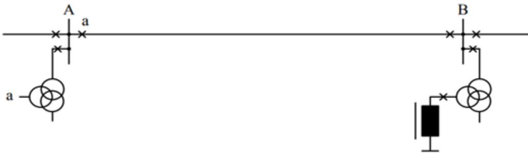
Slika 4.7 Kompensacijska prigušnica spojena na tercijar transformatora[20]
