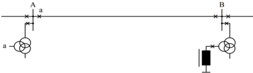
Slika 4.7 Kompensacijska prigušnica spojena na tercijar transformatora[20]
