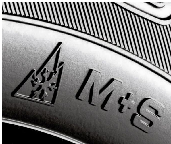
Slika 8. Oznaka M+S na pneumatiku
