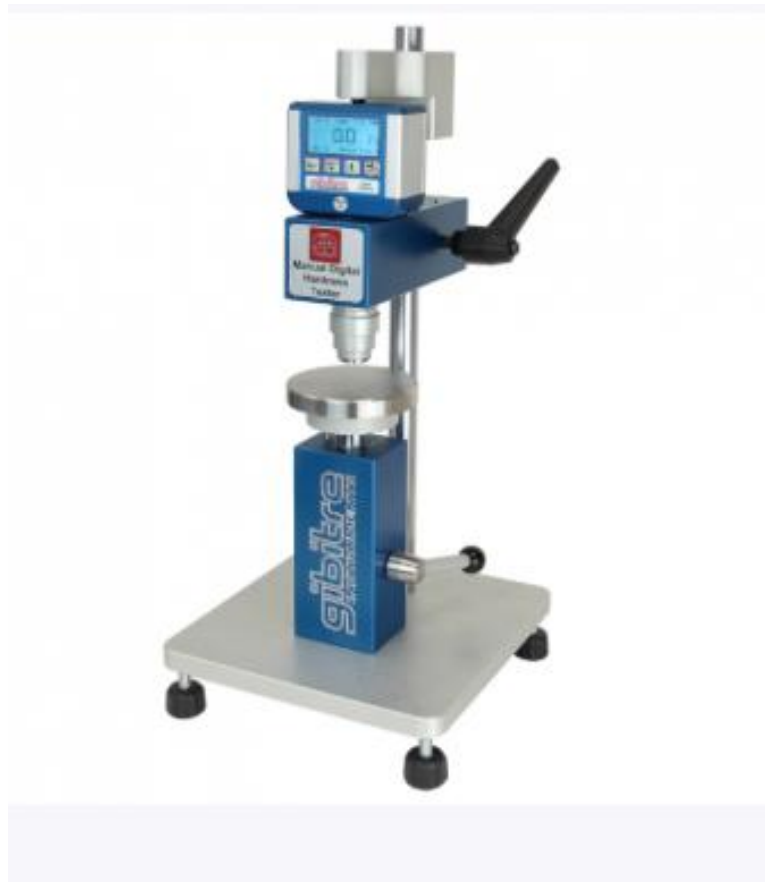
Slika 16 . Gibitre Manual Digital Hardness Tester – uređaj za ispitivanje tvrdoće
