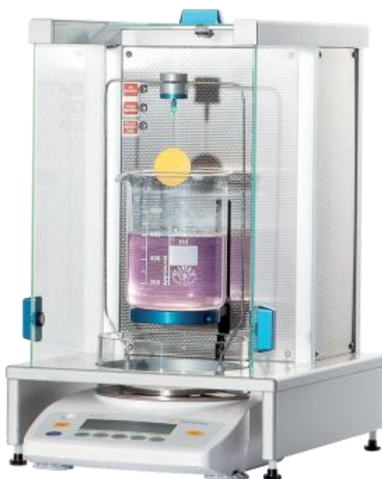
Slika 19. Gibitre Density Check - uređaj za ispitivanje gustoće
