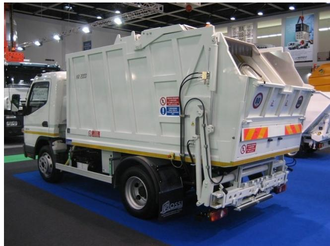
Slika 14. Vozilo za održavanje čistoće
