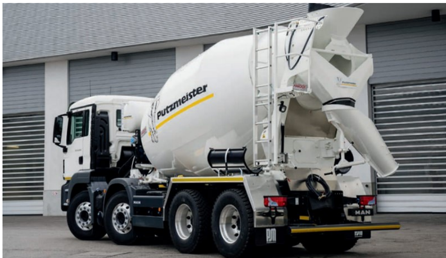
Slika 10. Cestovno vozilo za prijevoz građevnog materijala (mikser)
