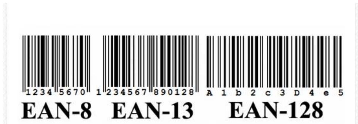
*Slika 5 Jednodimenzionalni bar kod*
