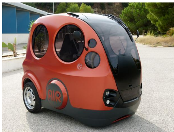
Slika 2.6. Automobil tvrtke Tata Motors koje pokreće zračni pogon, izvor: [22]
