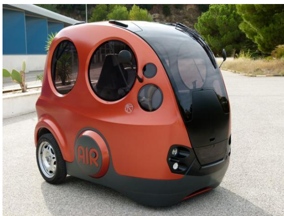
Slika 2.6. Automobil tvrtke Tata Motors koje pokreće zračni pogon, izvor: [22]
