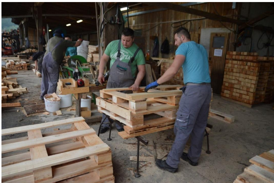
Slika 23. Spajanje dijelova u gotov proizvod – paletu
