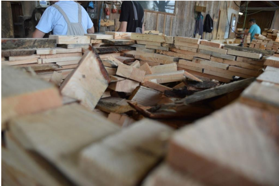
Slika 22. Neiskoristivi dijelovi u procesu izrade paleta
