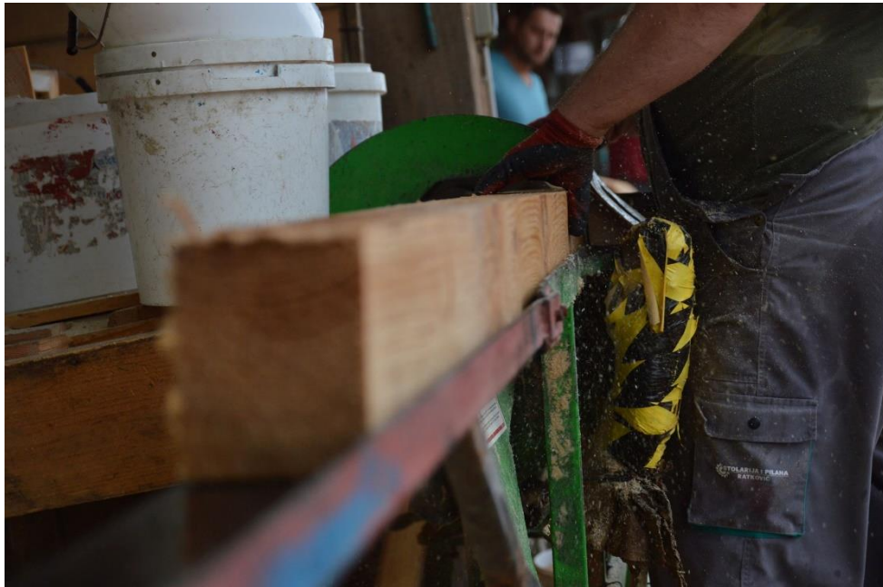
Slika 21. Rezanje građe na određene dimenzije
