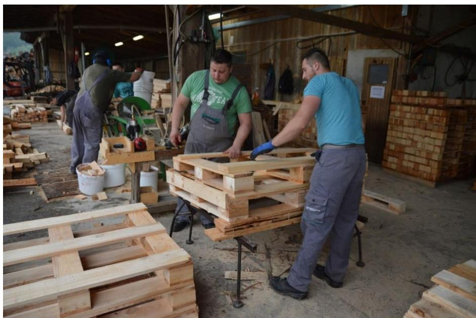
Slika 23. Spajanje dijelova u gotov proizvod – paletu
