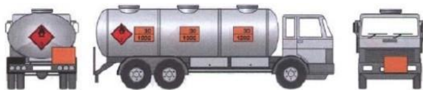
Slika 9.7 Označavanje cisterne s više spremnika
