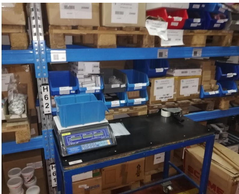
Slika 14. Vaga za vaganje sitnih dijelova
