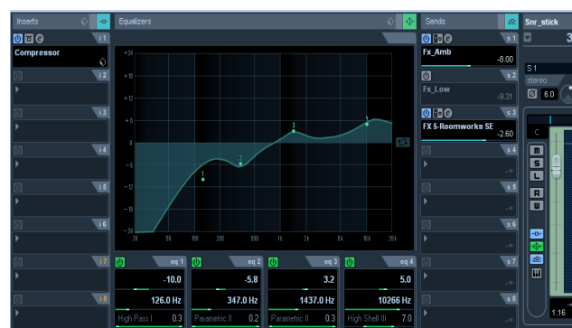
Slika 6.3.: Ekvalizacija obruč udarca
