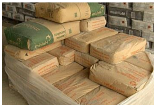
Slika 2.2 Primjer sekundarne ambalaže, paleta sa vrećama cementa omotana folijom
