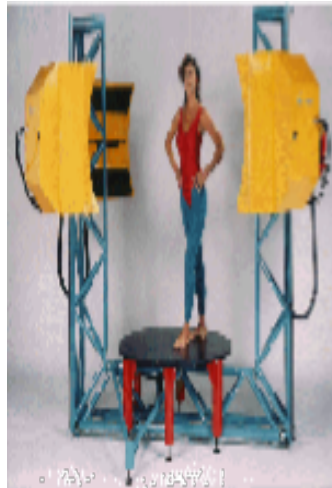
Slika 2.3. Skener cijelog tijela [1]
