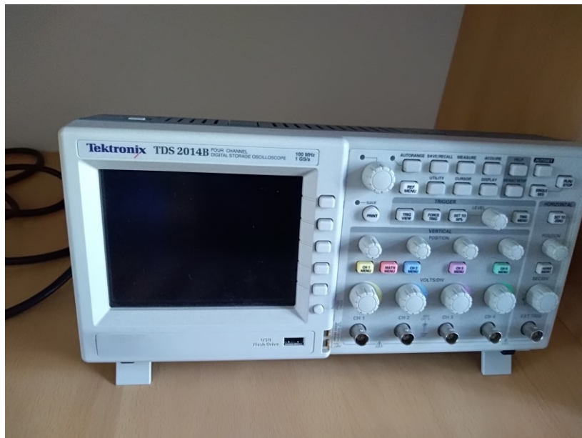
Slika 5.2 Osciloskop Tektronix TDS 2014
