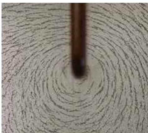
Slika 3.1 Magnetske silnice oko ravnog vodiča [9]
