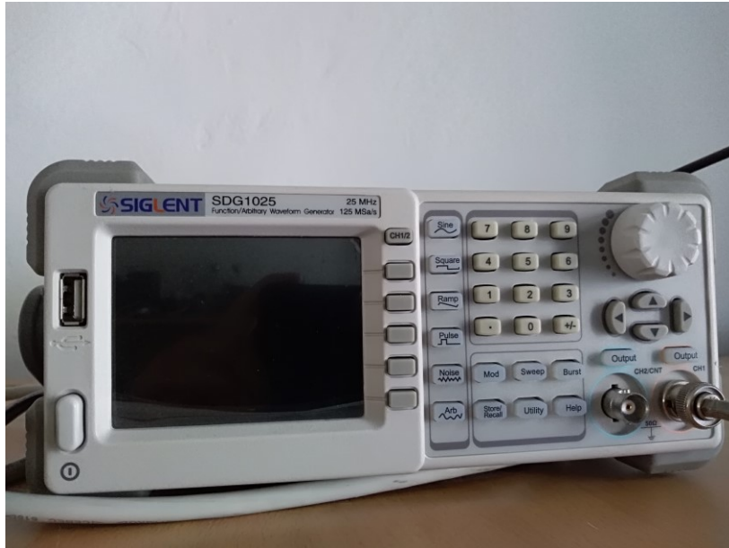
Slika 5.1 Funkcijski generator SIGLENT SDG 125
