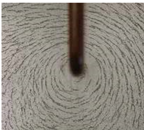
Slika 3.1 Magnetske silnice oko ravnog vodiča [9]
