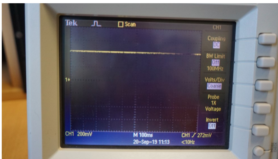
Slika 5.10 Ispeglani istosmjerni napon na sekundarnoj strani
