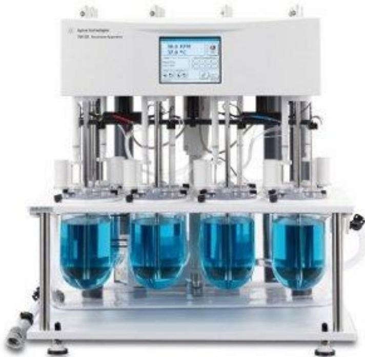
Slika 9: Dissolution apparatus [20]
