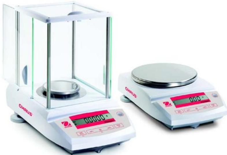
Slika 7: Analitička i tehnološka vaga [15]
