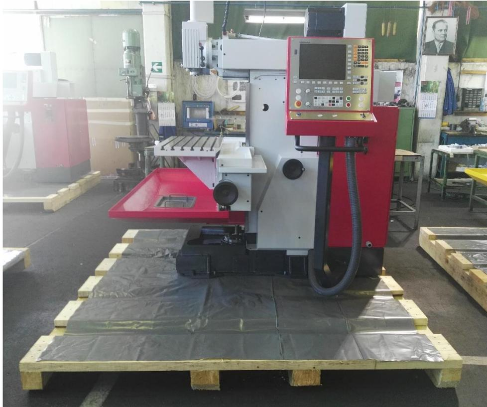
Slika 23. Stroj na specijalnoj paleti
