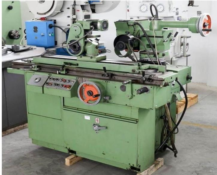
Slika 8. Oštrilica i brusilica alata GEOMETRIC univerzalna
