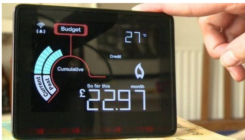
Slika 2.1. Uređaj za kontrolu potrošnje energije u kućanstvu
