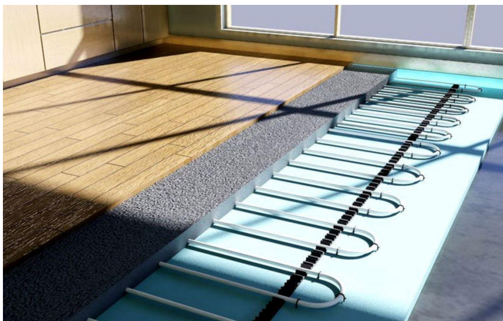
Slika 3.5. Prikaz polaganja podnog grijanja u slojevima poda
