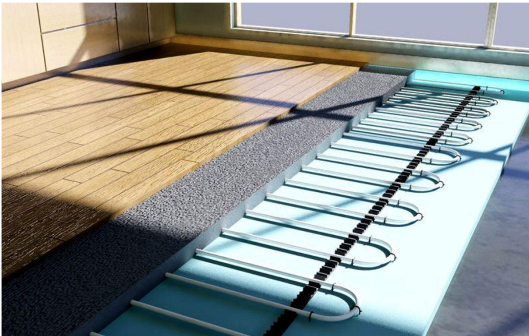
Slika 3.5. Prikaz polaganja podnog grijanja u slojevima poda
