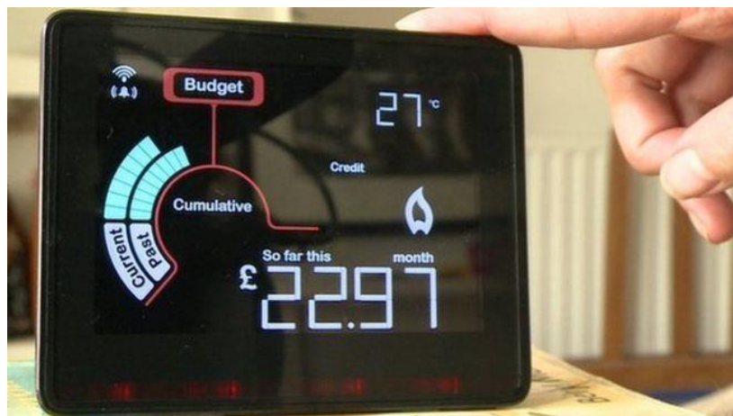
Slika 2.1. Uređaj za kontrolu potrošnje energije u kućanstvu
