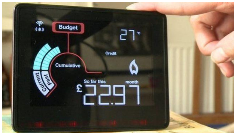
Slika 2.1. Uređaj za kontrolu potrošnje energije u kućanstvu
