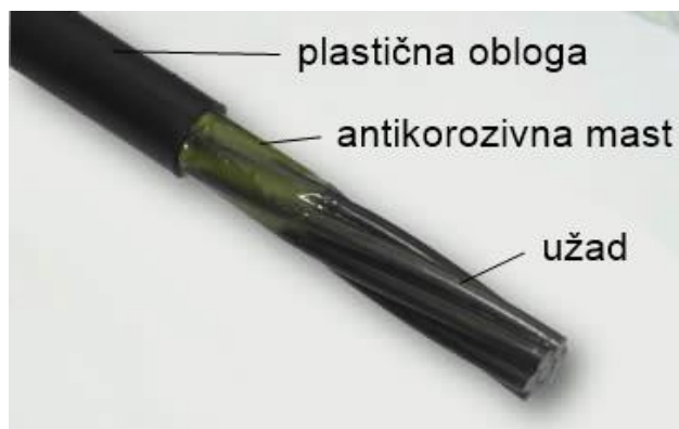
Slika 2.5. Unbonded kabel
