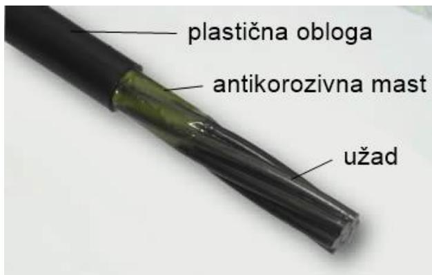
*Slika 2.5. Unbonded kabel*
