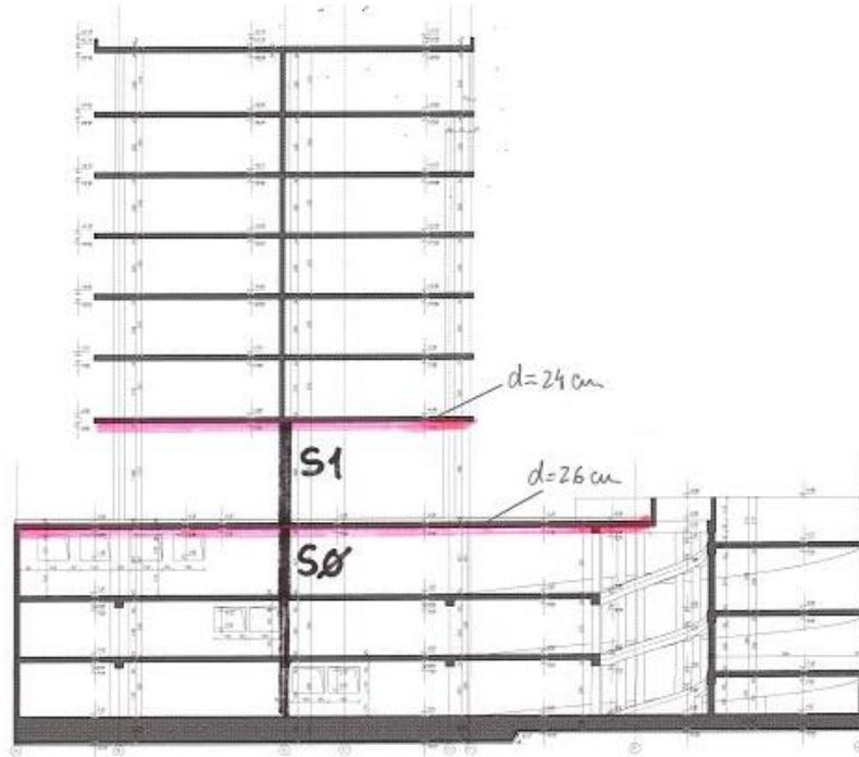
Slika 5.1. Presjek zgrade sa označenim stropnim pločama i stupovima za koje će raditi proračun
