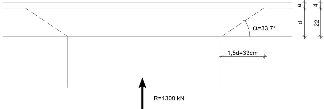
$d$  – osnovni kontrolni presjek, staticka visina ploče
