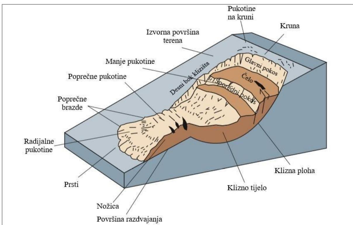
Slika 2.1. Dijelovi klizišta
