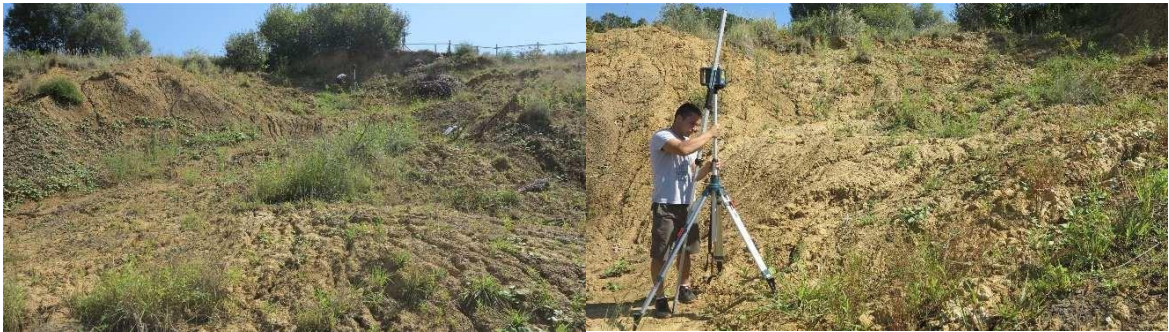
Slika 7.6. Mjerenje karakterističnih nagiba u zoni bušotine B11
