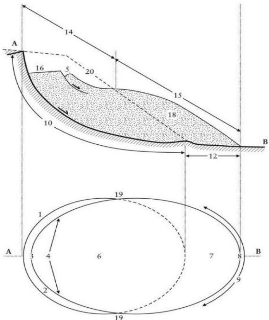
Slika 2.5.Dijelovi klizišta
