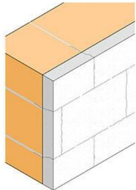
*Slika 2.5.3.6. Pukotine iz fuga podloge (Izvor: <https://www.roefix.hr/O-nama/Aktualno/Novosti/Pukotine-na-fasadi>)*
