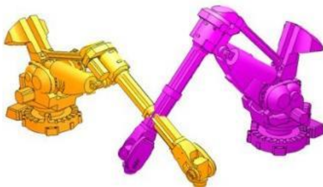
Slika 4-1 Detekcija sudara između dva manipulatora [14]
