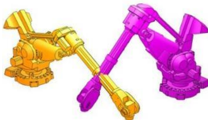
Slika 4-1 Detekcija sudara između dva manipulatora [14]
