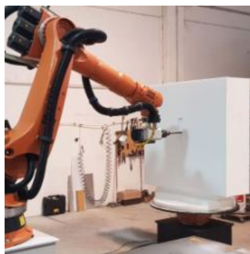
Slika 3-3 Glodanje polistirenske pjene [10]
