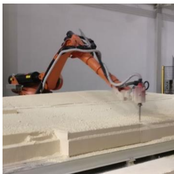
Slika 3-8 Glodanje u brodogradnji [10]
