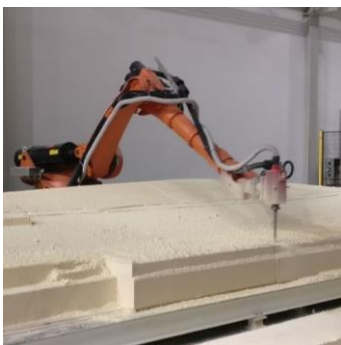
Slika 3-8 Glodanje u brodogradnji [10]
