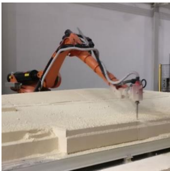
Slika 3-8 Glodanje u brodogradnji [10]
