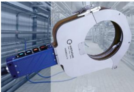
Slika 7.4.2. Zatvorena glava za orbitalno zavarivanje.[37]
