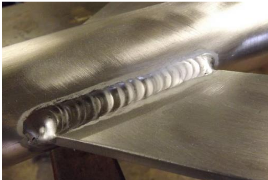
Slika 6.5. Izgled zavora aluminija TIG postupkom zavarivanja.[30]
