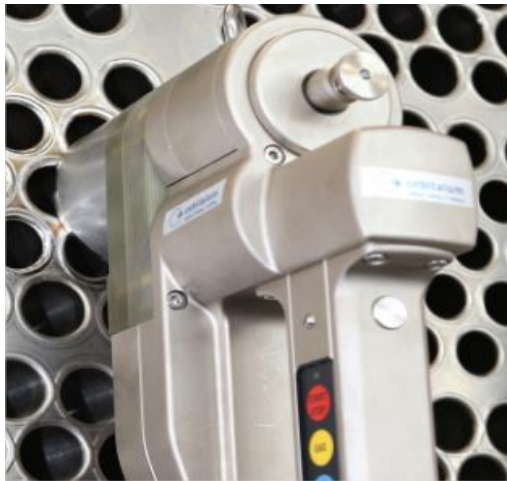
Slika 7.4.4. Glava za orbitalno zavarivanje cijev-cijevna stjena.[38]
