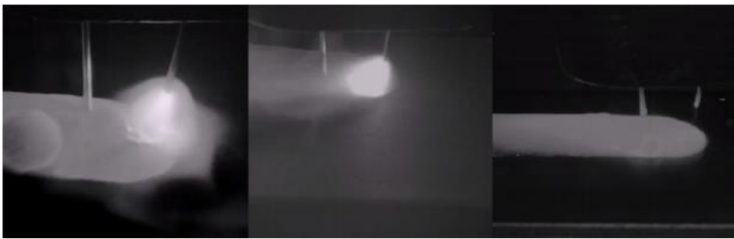
Slika 5.8.1. Realni prikaz prijenosa metala kod tandem zavarivanja.[7]
