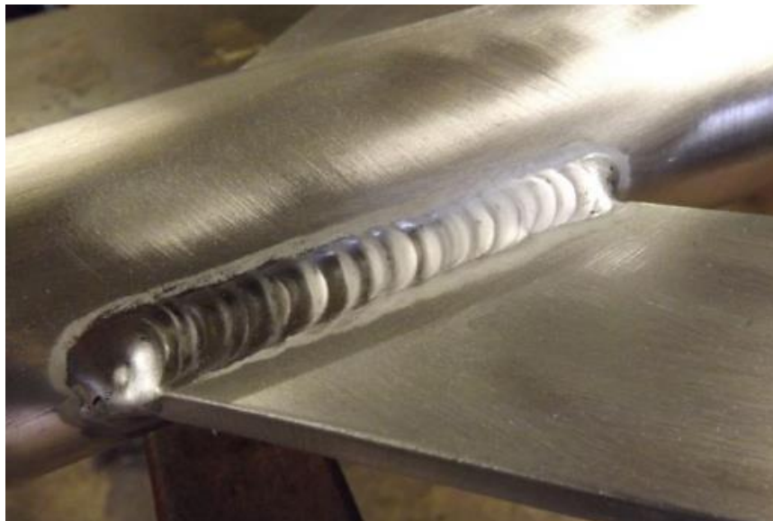
Slika 6.5. Izgled zavora aluminija TIG postupkom zavarivanja.[30]
