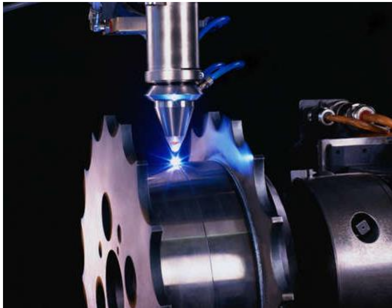
Slika 9.1. Primjer laserskog zavarivanja.[45]
