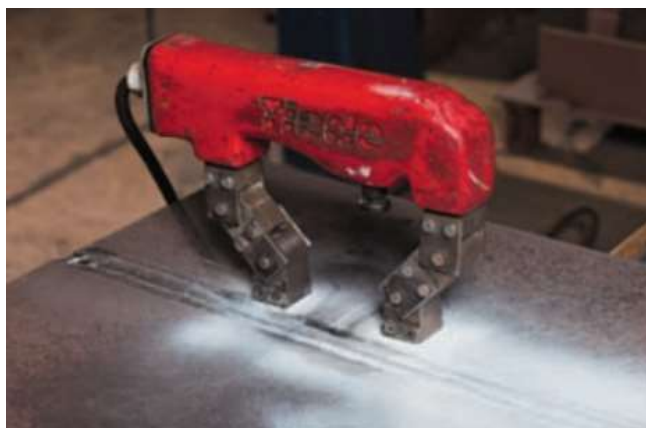
Slika 44 – Ispitivanje kvalitete zavara magnetskom metodom [16]
