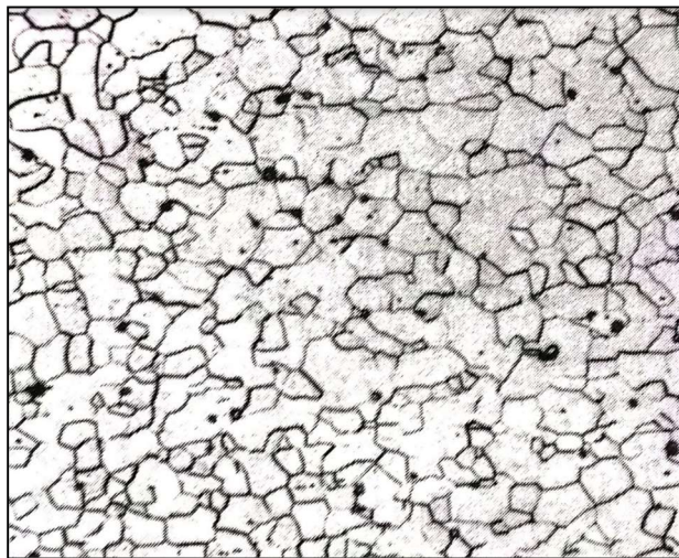
Slika 2 – Mikrostruktura feritnog čelika uvećana 100:1 [2]
