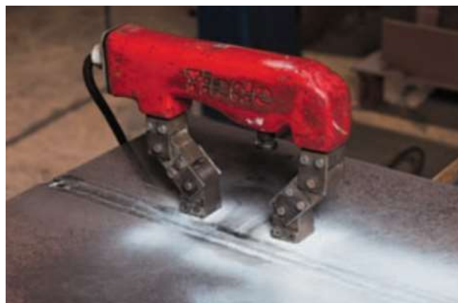
Slika 44 – Ispitivanje kvalitete zavara magnetskom metodom [16]
