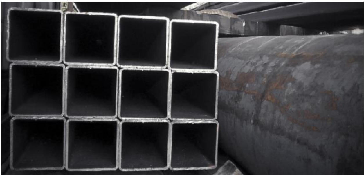
Slika 1: Toplo valjani šuplji profil [3]
