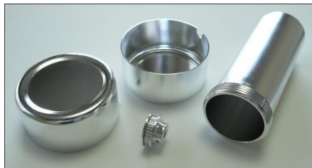
Slika 44.: Primjer kemijski poliranih predmeta [37]
