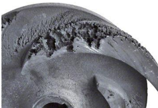
Slika 15.: Primjer kavitacijske korozije [16]
