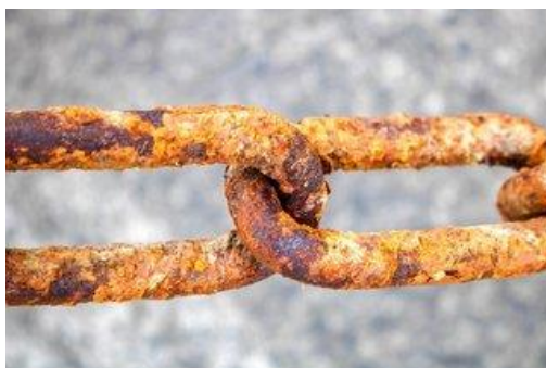
Slika 4.: Primjer opće površinske korozije [5]
