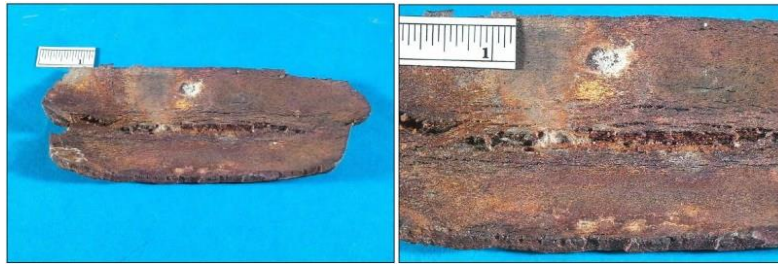
Slika 13.: Primjer korozijskog umora u cijevi bojlera [14]
