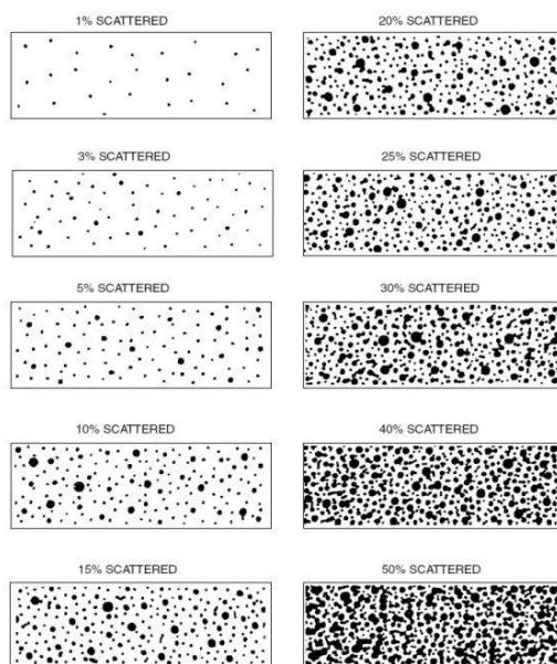
Slika 6.: Prikaz intenziteta rupičaste korozije [6]
