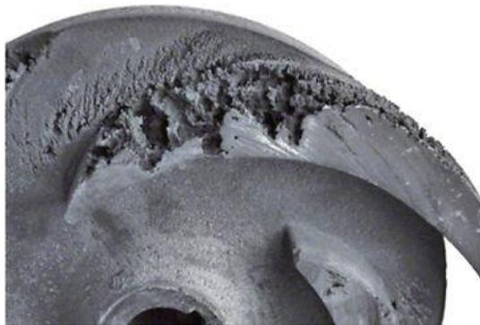
*Slika 15.: Primjer kavitacijske korozije [16]*
