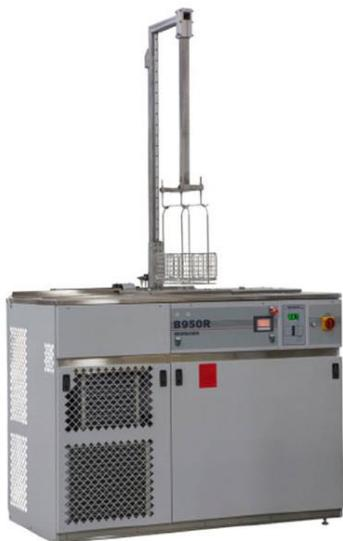
Slika 46.: Oprema za parno odmašćivanje [39]
