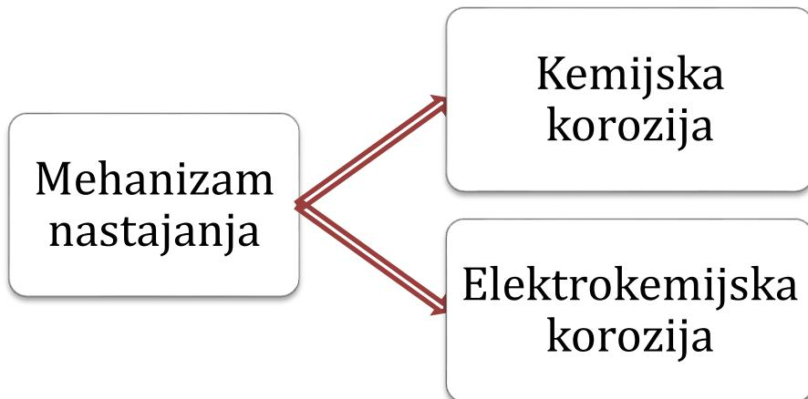
Slika 1.: Shematski prikaz podjele korozije prema mehanizmu procesa
