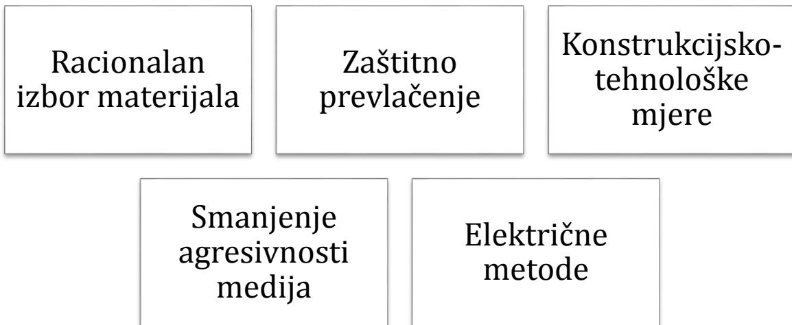
*Slika 17.: Prikaz metoda zaštite prema načinu provođenja*
