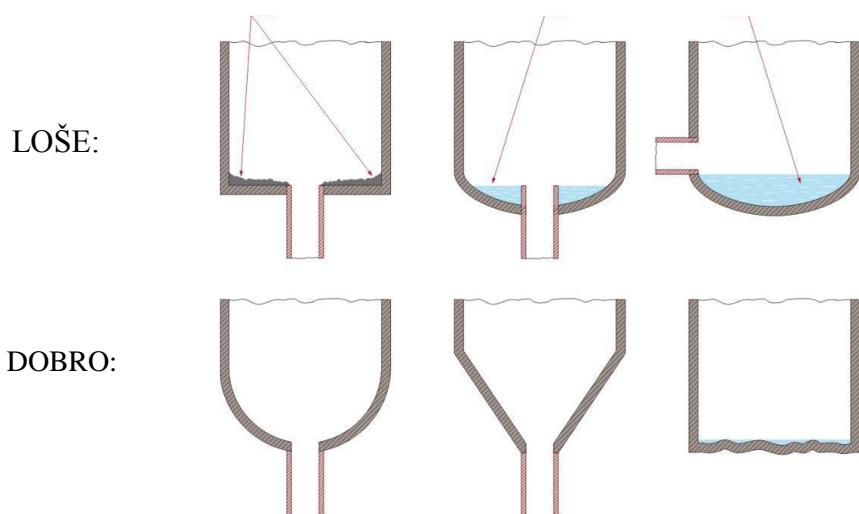
Slika 31.: Primjeri lošeg i dobrog konstruiranja spremnika
