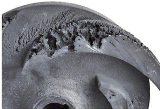
Slika 15.: Primjer kavitacijske korozije [16]
