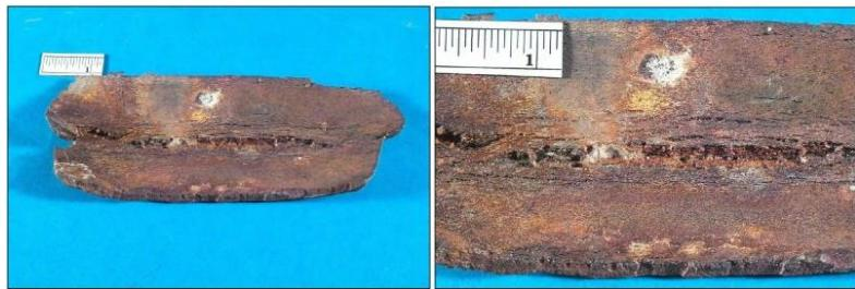
*Slika 13.: Primjer korozijiskog umora u cijevi bojlera [14]*
