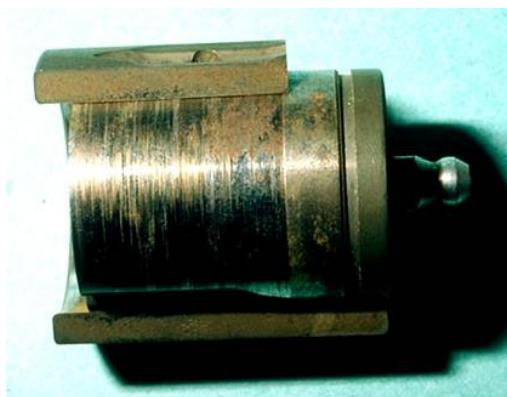
*Slika 16.: Primjer tarne korozije na strojnom dijelu [17]*
