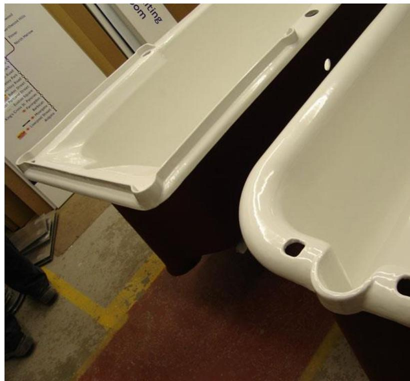
Slika 27.: Primjer emajliranih kada [27]
