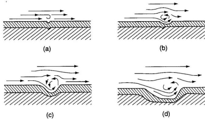
*Slika 14.: Shematski prikaz procesa erozijske korozije [15]*
