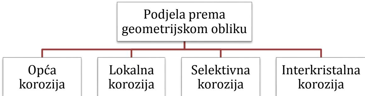
Slika 3.: Shematski prikaz podjele prema geometrijskom obliku koroziskog razaranja
