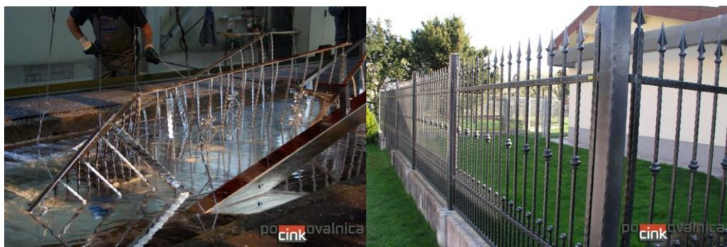
Slika 20.: Postupak pocinčavanja (lijevo); primjer pocinčane ograde (desno) [19]
