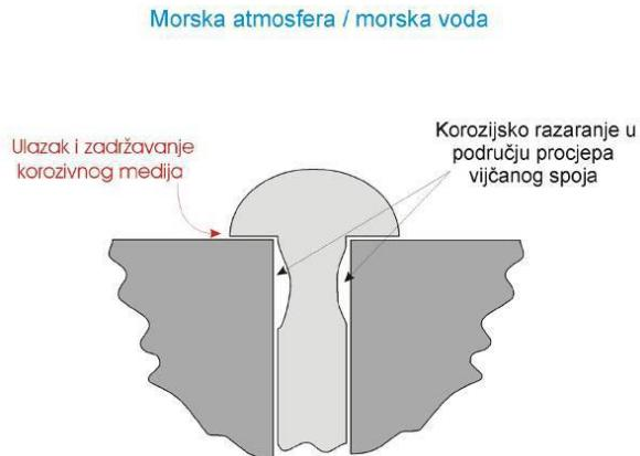
Slika 8.: Shema mehanizma oštećivanja vijčanog spoja pod utjecajem morske vode [7]
