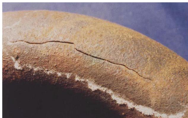
Slika 12.: Primjer napetosne korozije [12]
