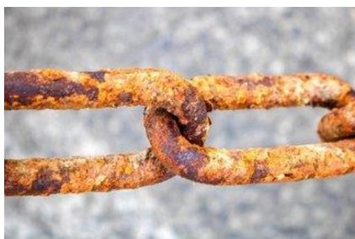
Slika 4.: Primjer opće površinske korozije [5]
