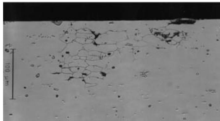
Slika 11.: Prikaz interkristalne korozije ispod površine [11]
