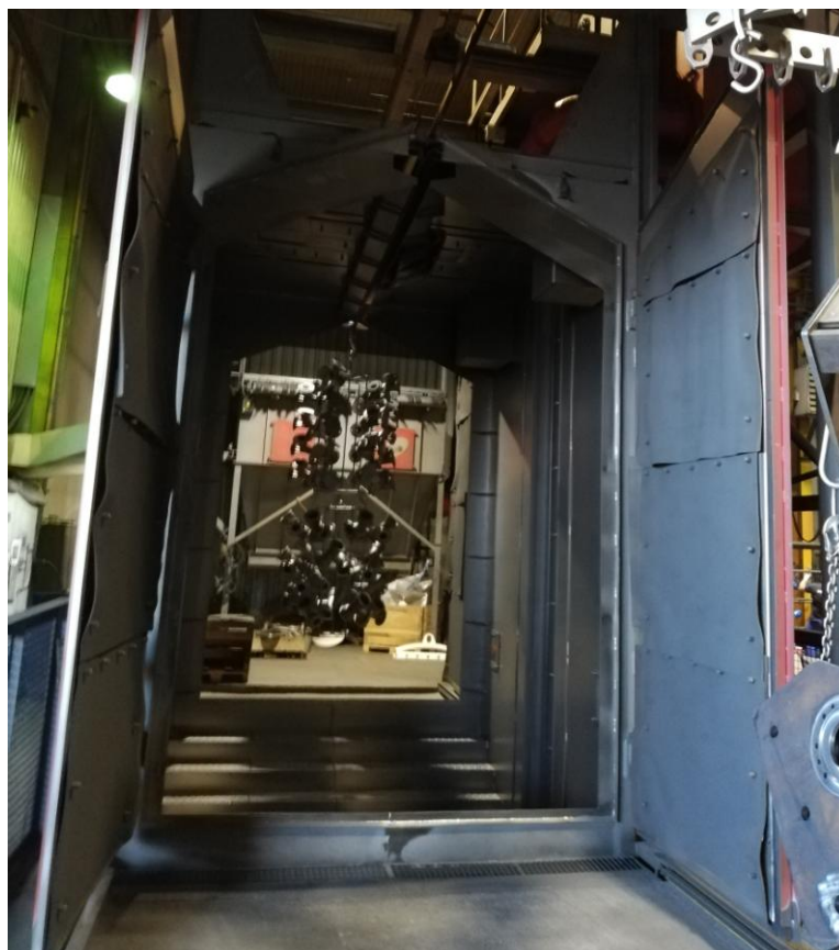
Slika 2.2 Jedinica za sačmarenje odljevaka [5]
