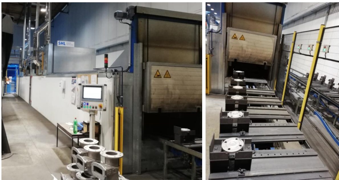
Slika 2.12 Peć za predgrijavanje odljevaka [13]
